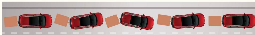
Afin que vous puissiez tracter une remorque en toute sécurité, le système de stabilisation du remorquage TSA (Trailer Stability Assist) surveille en permanence l'alignement entre la remorque et le CR-V. Lorsqu'il détecte un
